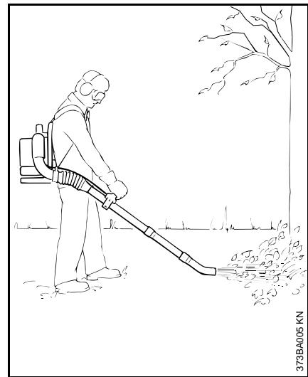
La máquina se lleva a la espalda. La mano derecha guía el tubo soplador por la empuñadura de mando.
